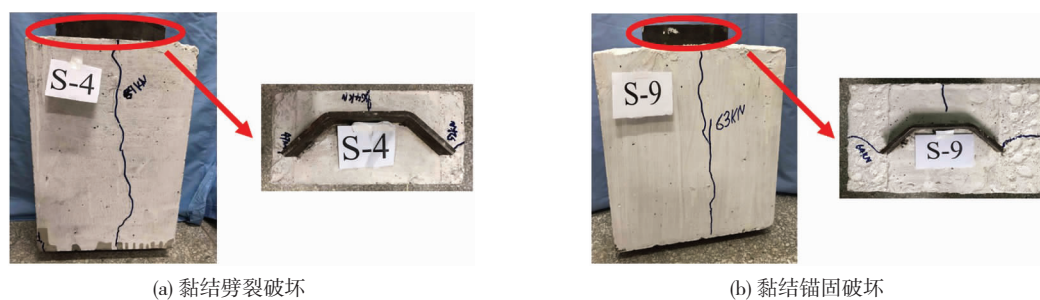
图 5 试件破坏形态
